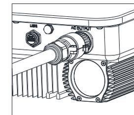
Abb. 6.4 AC-Schnellanschluss-Schema
