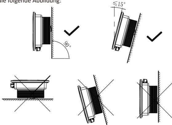
Abb. 5.1 Installationsschema
