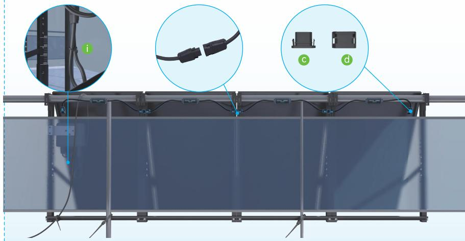
1. Verbinden Sie die Kabel zwischen den Modulen
