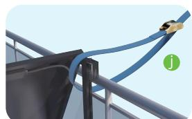
1. Führen Sie das Ende des Sicherheitsseils abwechselnd durch das Geländer und den Bügel
